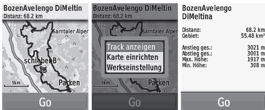
Abbildung 4-20 eTrex 30: Barometrische Höhenangaben aufrufen
