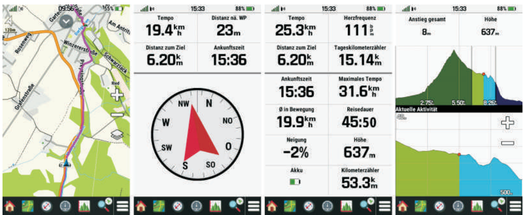
Abbildung 1-18: 4 Seiten mit Information während der Tour: Karten-Ansicht, Kompass/Fahrtrichtungszeiger, Reisecomputer, Höhenmesser
